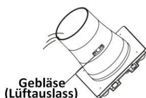
**ATTENTION: Tasten Diffusor Sind nicht wasserdicht und darf nicht mit Wasser in Berührung. Nicht eintauchen des Diffusors. Lassen Sie das Wasser nicht in die Gebläse (Luftaußlass), kann dies zu Fehlfunktionen aufgrund Diffusors. Für einen vollständigen Stillstand, ziehen Sie das Netzkabel.**
